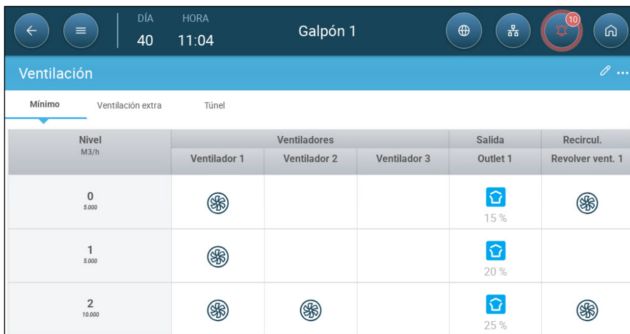
Figure 5: Cambio en los extractores – el ventilador de recirculación continúa operando
