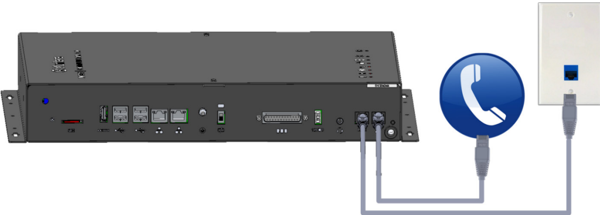
Şekil 8: Telefon Hattına Bağlanması
