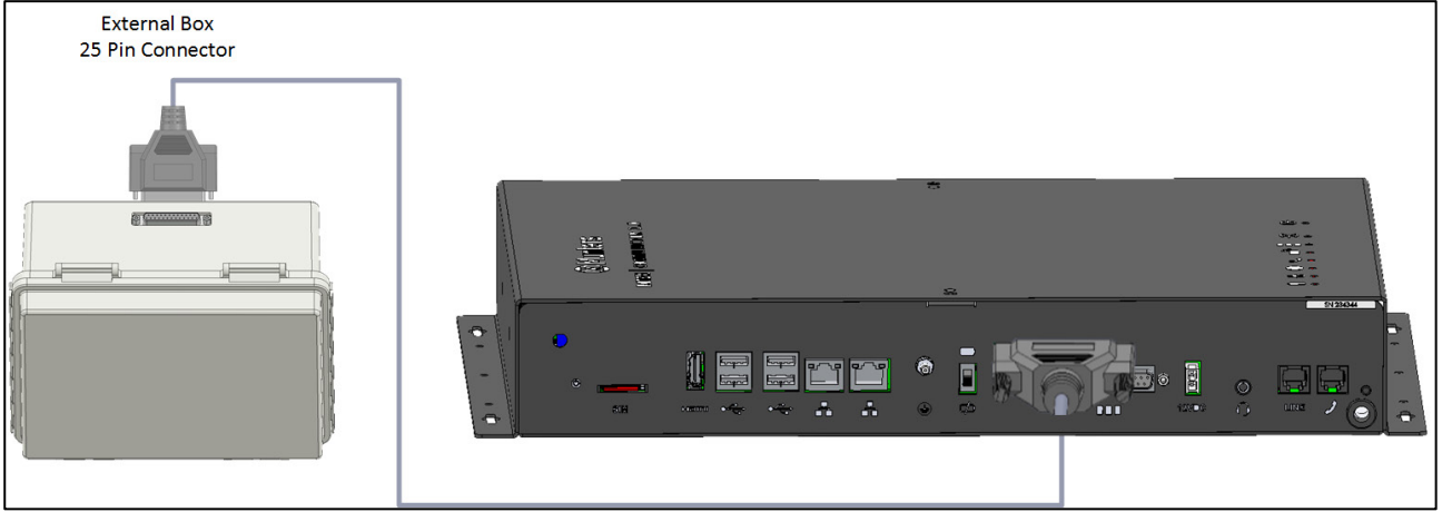
Şekil 26: T-Box'un Communicator 2.0 Plus Bağlanması
