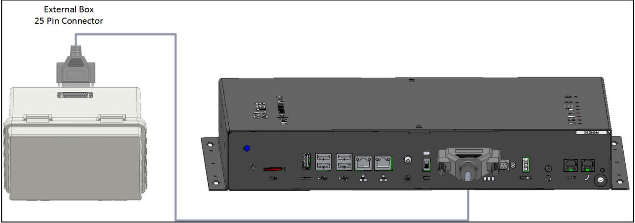
الشكل 26: T-Box – Communicator 2.0 Plus اتصال
