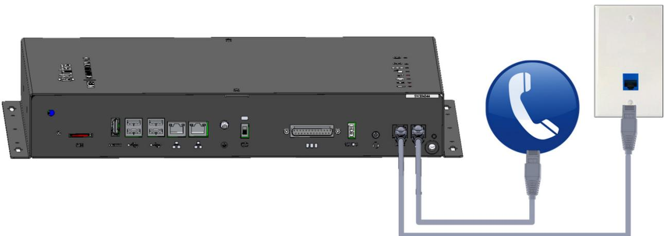
Figura 8: Conexión de Línea Telefónica
