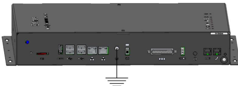
Figura 6: Esquema de puesta a tierra
