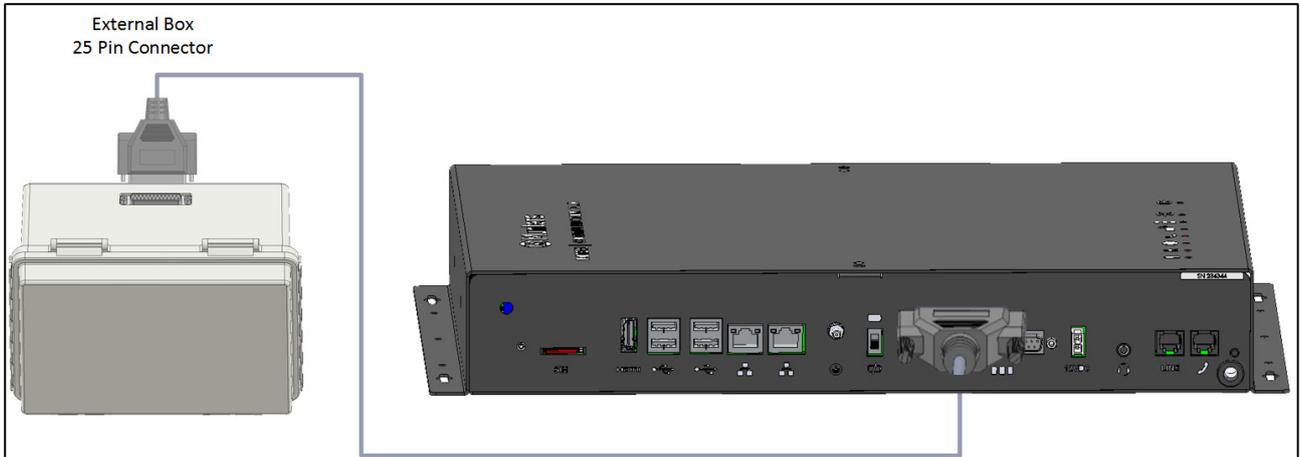
Figura 26: Conexión T-Box – Communicator 2.0 Plus
