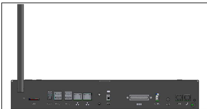
Si el Communicator 2.0 Plus viene con un módem celular, acoplar la antena.
