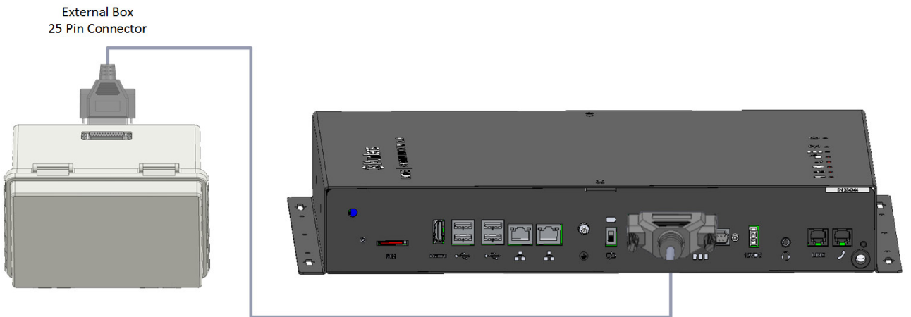
الشكل 12: العلبة الخارجية - كابل جهاز Communicator 2.0
