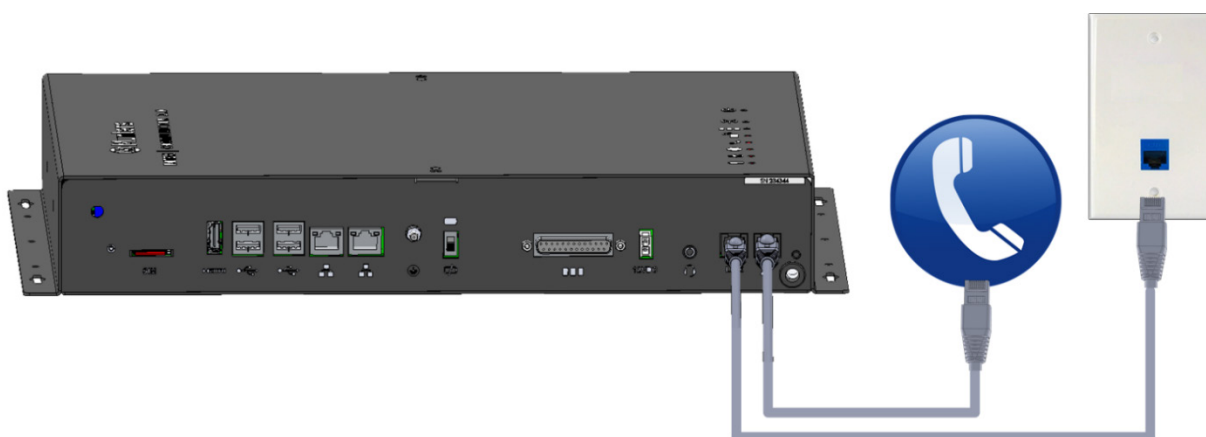
Figura 8: Conexión de Línea Telefónica
