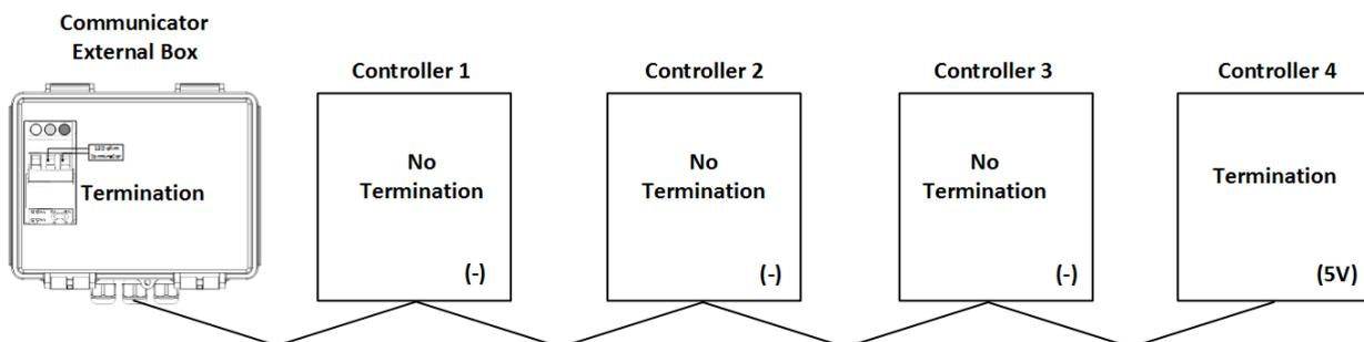
Figura 23: Terminación de caja externa/controlador
