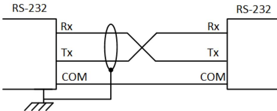
Figura 20: Cableado de RS-232 Tarjeta de la Comunicación
