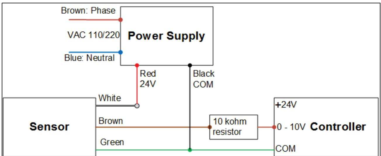
Figura 16: Cableado del Sensor de Amnaco
