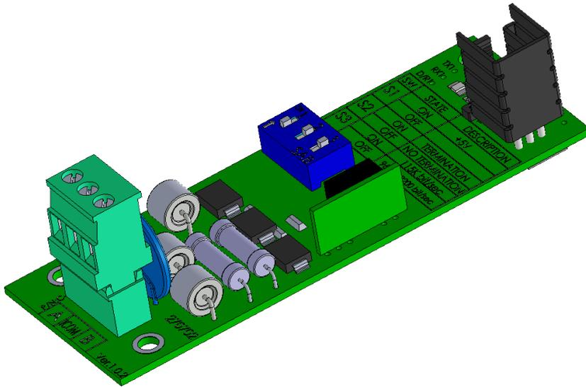
Figura 19: Tarjeta RNET RS-485 Aislado (P/N: 905-99-00003)
