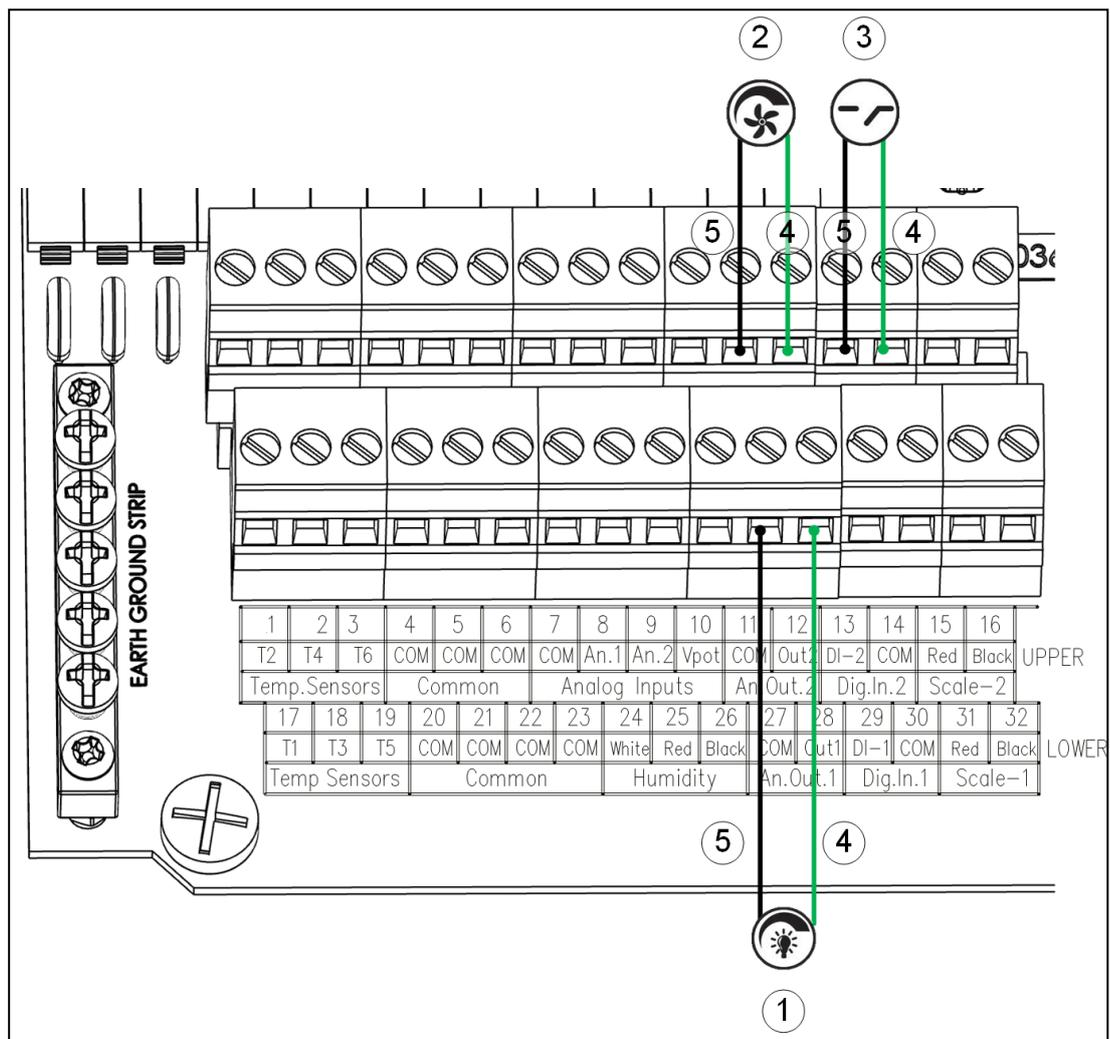
Figura 14: Salida Analógica y Dispositivos Digitales (ejemplo)
